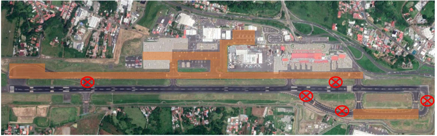
Imagen # 3 Esquema de operación de calles de rodaje durante fallo de borde de pista y calle de rodaje
