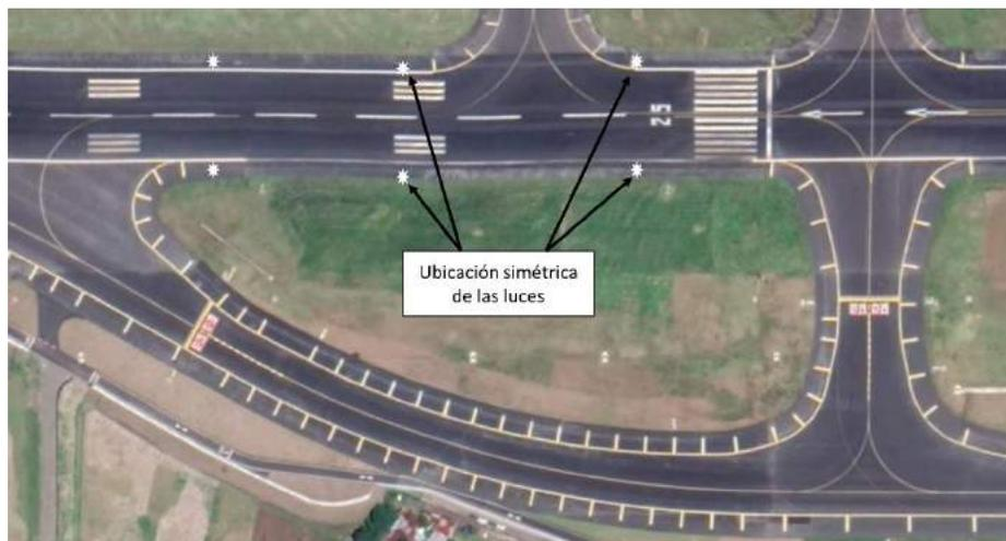
**Las luces de borde de pista empotradas se instalarán únicamente en los casos donde la falla también afecte las luces de borde de calle de rodaje.**
